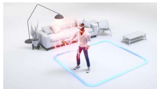
Fig. 5d – Segnalazione del superamento della griglia di controllo: pericolo.
